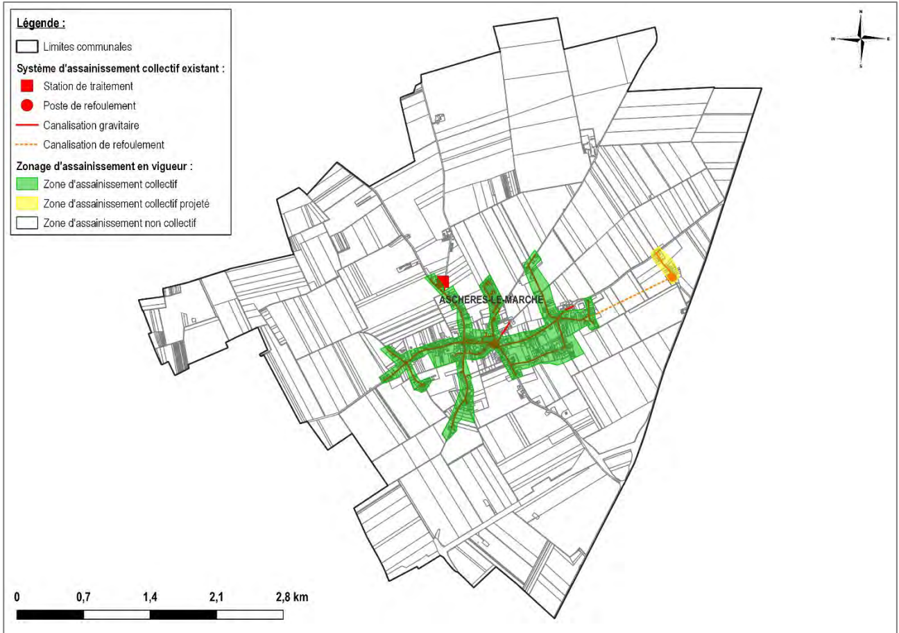
Figure 25 : Extrait du zonage d'assainissement d'Asnières-le-Marché
